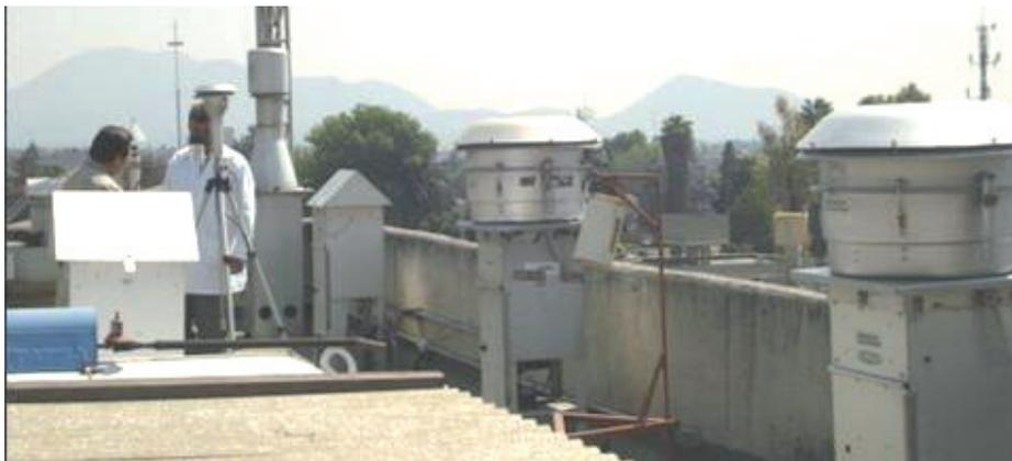
*Figura 15. Muestreadores de alto volumen con cabezal.*
